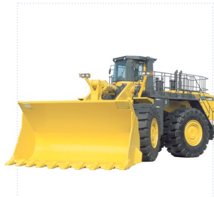
Cargador frontal Komatsu WA900 con potencia de 856 HP y capacidad de peso operacional de 102.880 Kg.
