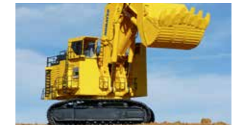
Pala hidráulica frontal eléctrica Komatsu PC8000-6 FS E con potencia bruta de 2.900 HP y 752 toneladas de peso operacional.
