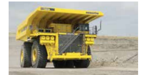
Camión Komatsu 960E-2K con capacidad de carga de 360 toneladas y potencia bruta de 3.500 HP.
