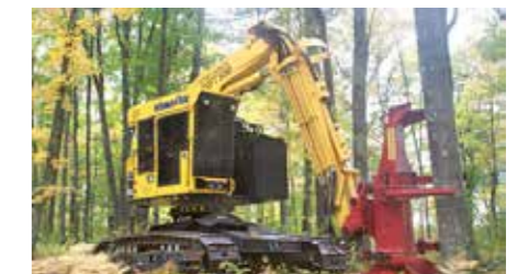
Volteador Feller Buncher XT450L-2 cuenta con una potencia de 300 HP, un torque de 1.356 Nm / 1.500rpm y un peso de operación de 31.500 KG.
