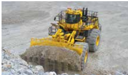
Cargador Frontal WA1200-6 , posee una potencia bruta de 1.892 HP, peso operacional de 220,00 toneladas y una capacidad de balde de 20,0 metros cúbicos.
