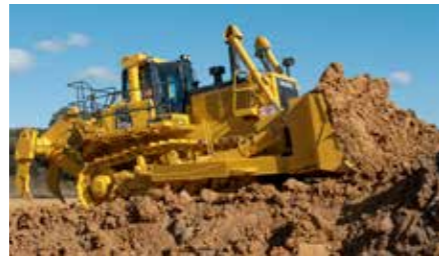
Bulldozer Komatsu D375 con potencia de 525 HP y capacidad de peso operacional de 69.560 Kg.
