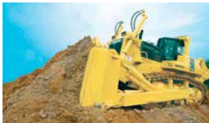
Tractores Sobre Oruga / Bulldozers D475A-5 SD cuenta con un peso de operación de 113 toneladas, potencia bruta de 899 HP y una capacidad de balde de 45 metros cúbicos.
