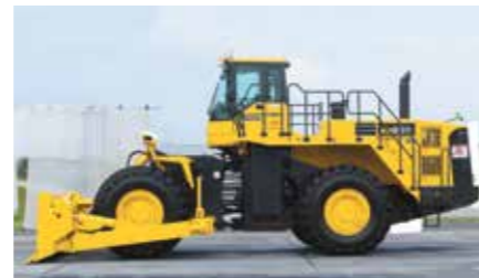
Tractores Sobre Neumáticos / Wheel Dozers WD600-3. Posee un peso de operación de 42,90 toneladas, una potencia neta de 485HP y una capacidad hoja de 8,0 metros cúbicos,
