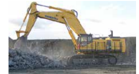
Excavadora Komatsu PC1250-8 con potencia de 672 HP y capacidad de peso operacional de 109.900 Kg.
