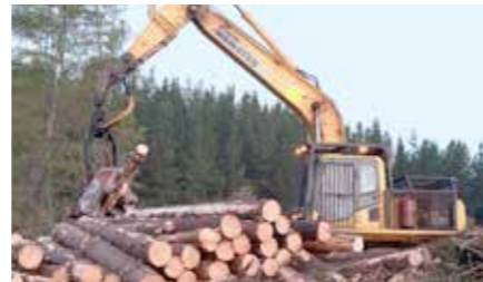
Procesador PC220LC-8, tiene un peso de operación de 27.700 Kg. Cabezal Waratah-HTH622B.
