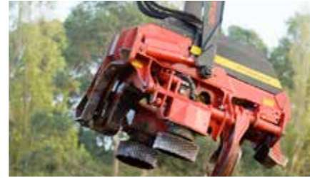
Cabezal Waratah-HTH622B, el peso de operación es de 2.120 Kg. Cuenta con un diámetro máximo de 600 mm y una presión de 4.641 psi / 32 Mpa.
