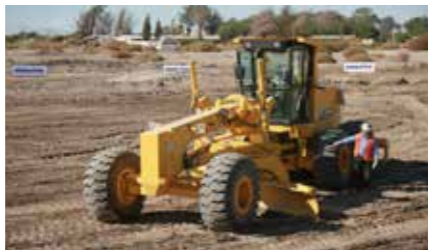
Motoniveladora / Moto Grader GD825A-2 tiene un peso de operación de 26,35 toneladas, un largo de hoja de 16 pies y una potencia Neta de 280 HP.
